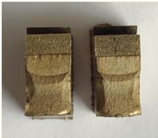
Figura 6.- Superficie de fractura después de quebrar las probetas. Lado izquierdo realizado con dispositivo patentado, lado derecho realizado con máquina servo-hidráulica.
