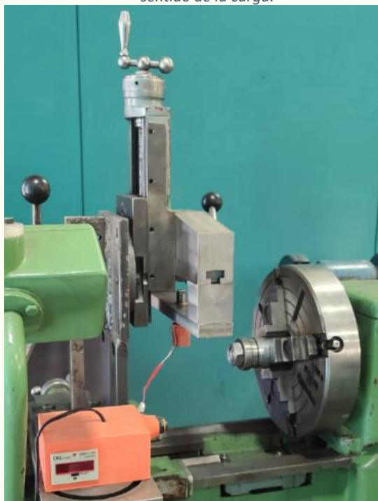
Figura 14. Sistema para contabilizar los ciclos y célula de carga adaptada en el apoyo que genera la carga cíclica.
