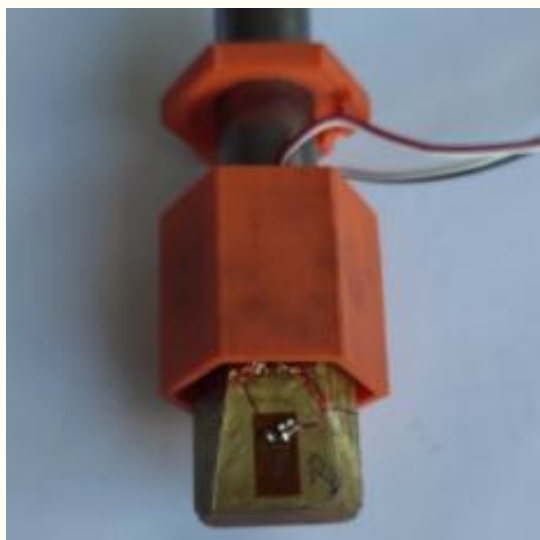
Figura 13.- Strain gauge para medir la deformación en el sentido de la carga.
