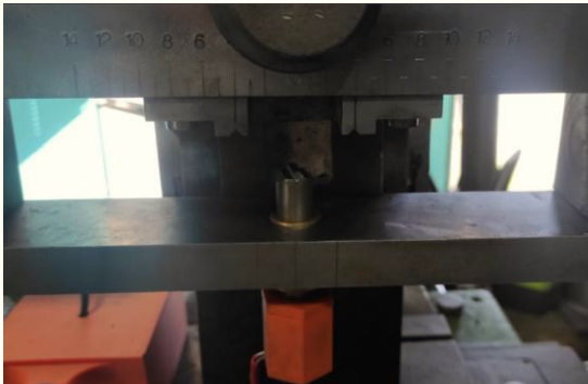
Figura 8.- Conjunto de soporte en 3 puntos.
