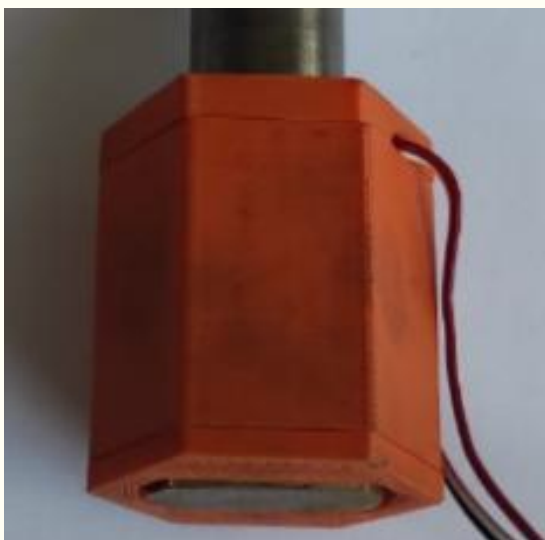
Figura 11.- Celda de carga diseñada para medir carga aplicada.
