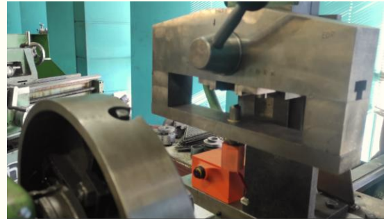
Figura 9.- Travesaño carga en 3 puntos.
