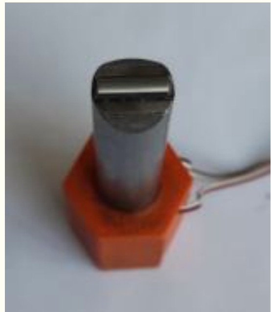
Figura 10.- rodillo apoyo central, diámetro de acuerdo con norma ASTM E1820.
