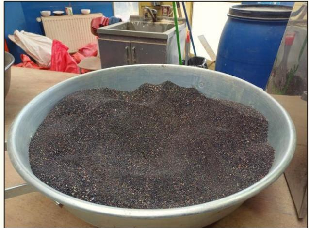
Fig. 2.2: Escoria de Cobre Granallada en Laboratorio.
