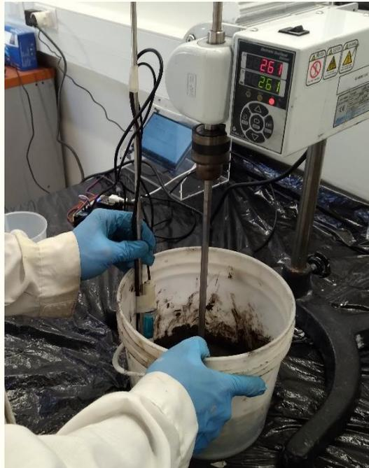
Figura 9 Medición de pH y temperatura durante la agitación de las mezclas.
