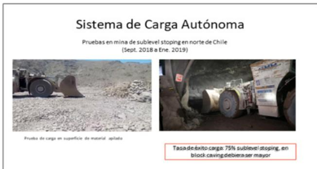
En la figura (abajo) se muestra nuestro prototipo de LHD autónomo desplazándose en una Mina subterránea chilena, de la región de Coquimbo.
